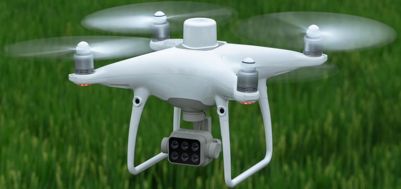
精靈 4 多光譜版是一款配備一體式多光譜成像系統的航測無人機，可採集高精度多光譜資料，助力農業監測與環境監察工作高效完成。
